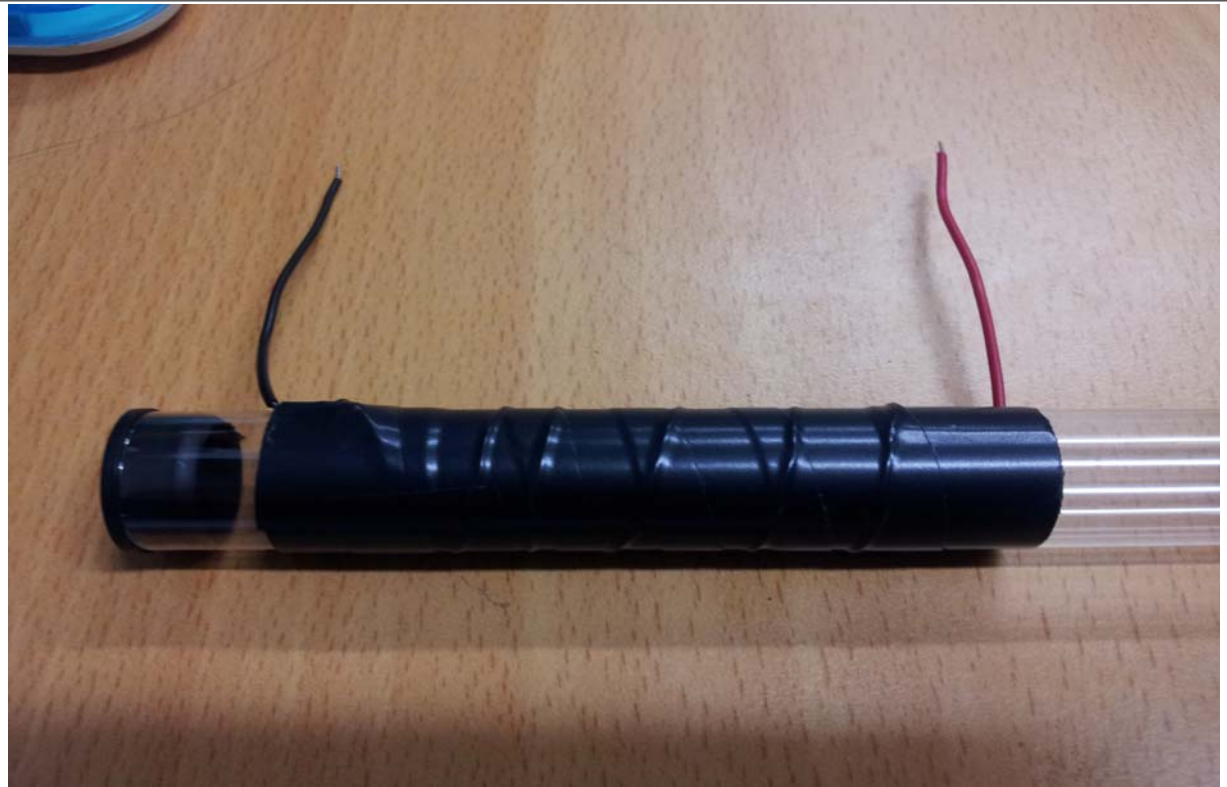
최종 실험계산치를 이용하여 제작된 열선부분이다. 손으로 잡을수 있게 간편하게 제작되었다.
