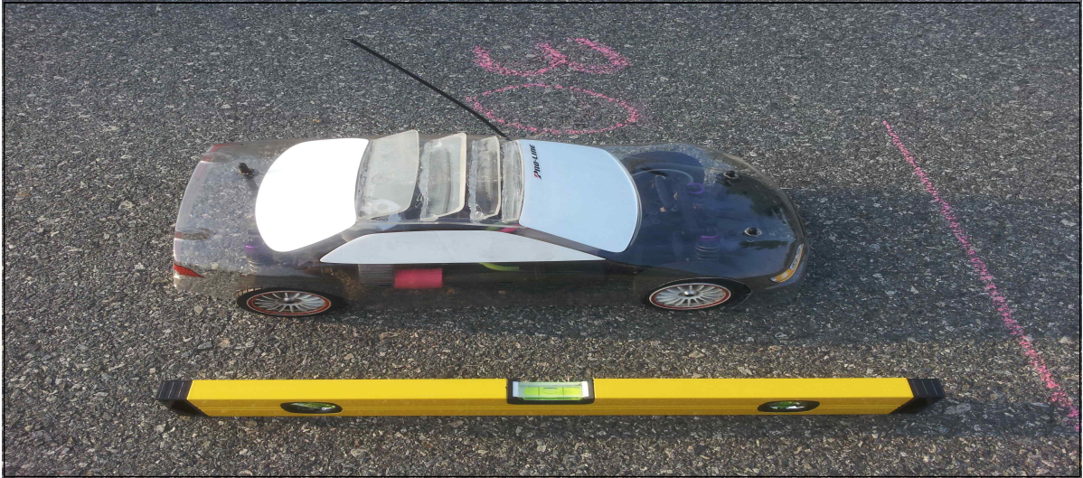
그림 4-2 30°의 스포일러를 모형 자동차에 설치한 모습
