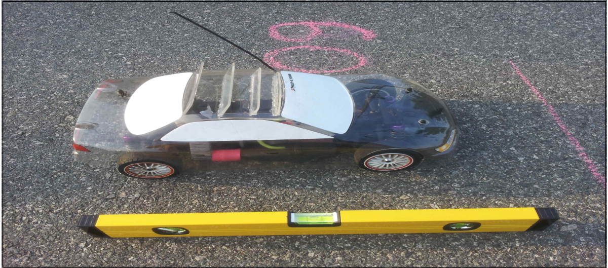
그림 4-4 60°의 스포일러를 모형 자동차에 설치한 모습
