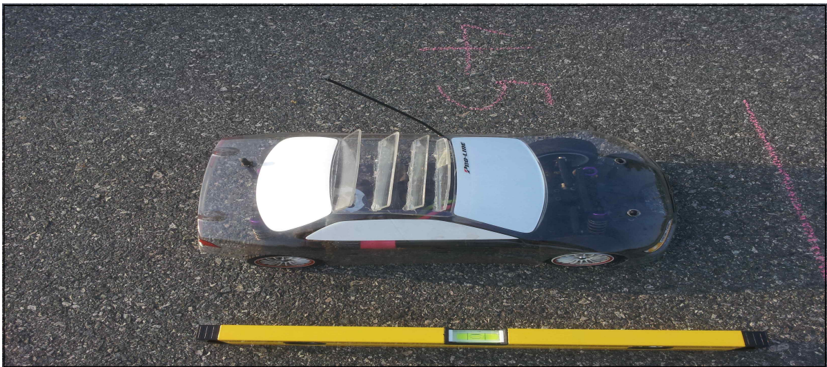
그림 4-3 45°의 스포일러를 모형 자동차에 설치한 모습
